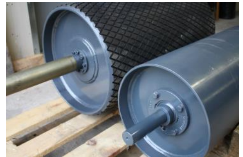
Drivtrumma med klämförband och gummibeläggning samt en vändtrumman med inv. lager.
